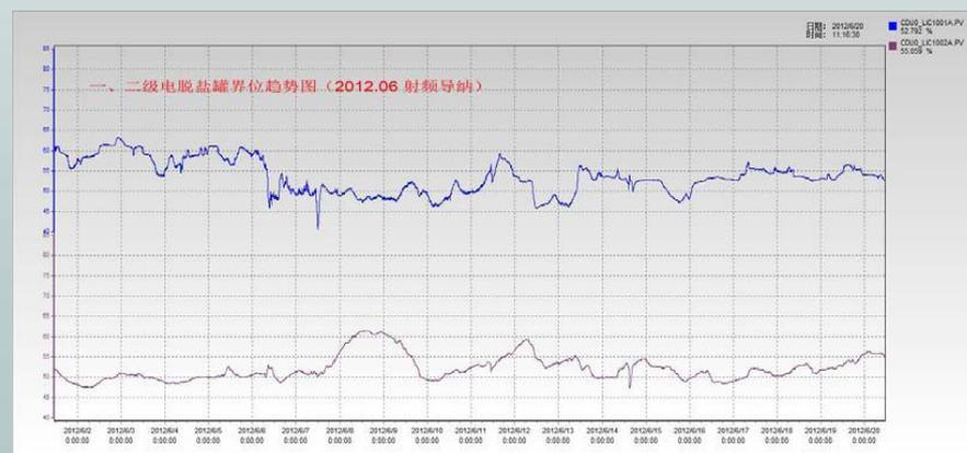
图2 射频导纳控制一二级电脱盐罐界位趋势图
